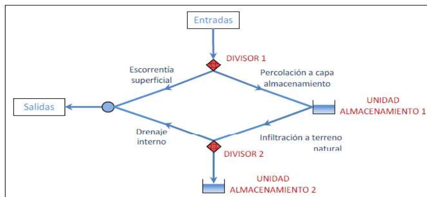
Figura 7. Conceptualización de un pavimento poroso en SWMM
